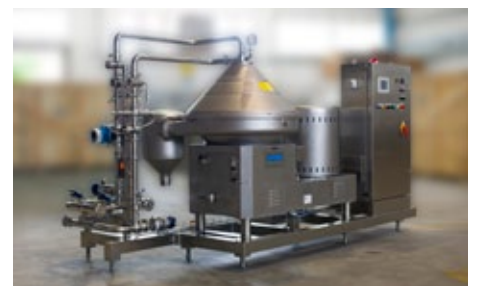
▲ Centrífuga Separadora ANDRITZ
