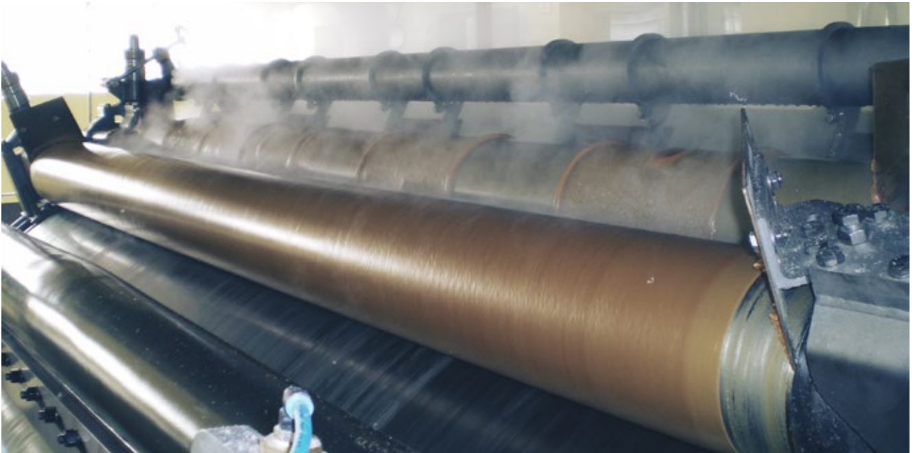
Secagem de amido em secador de tambor
