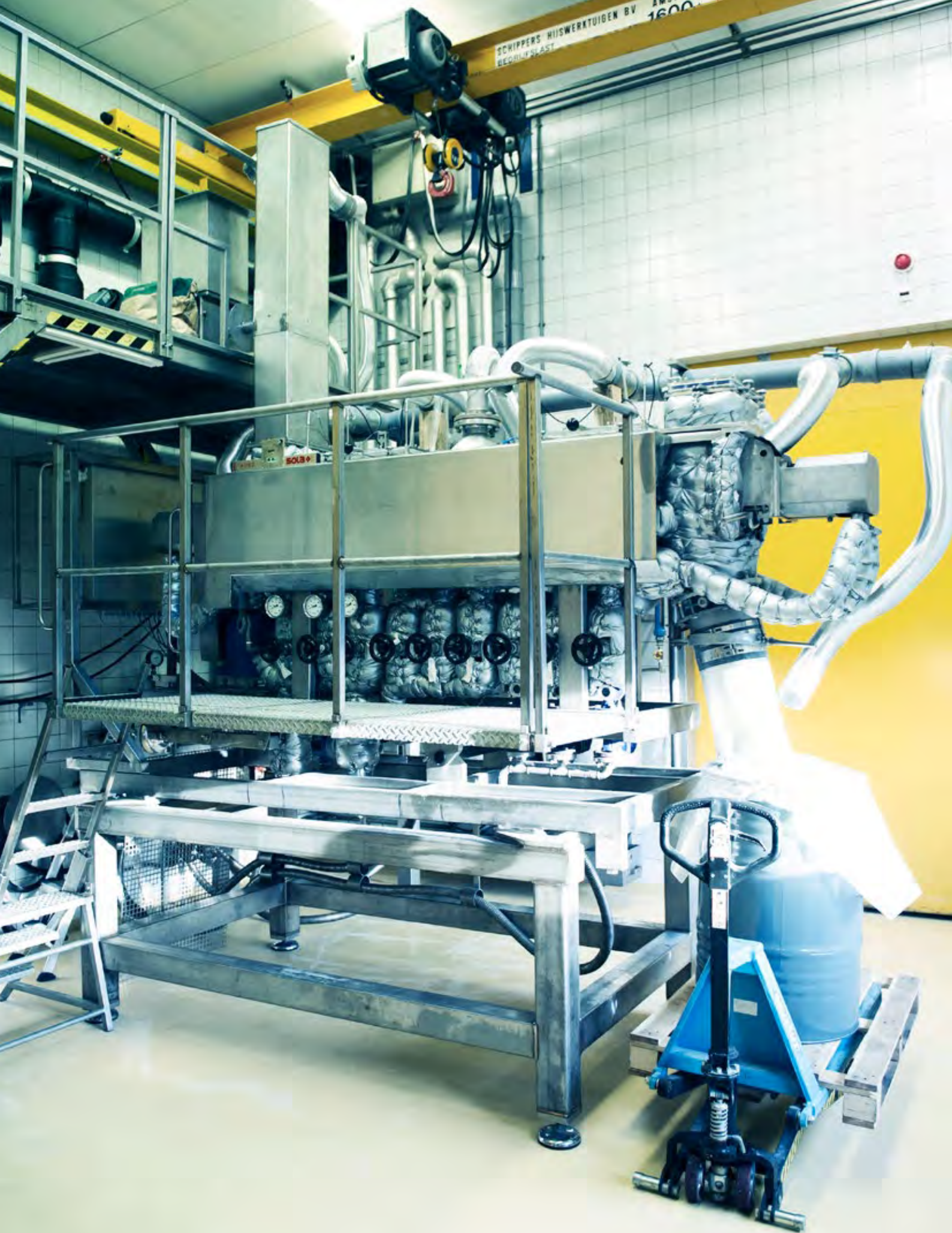
Secador de pás piloto ANDRITZ Gouda
