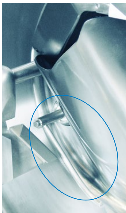
Instalação do Controle de Alimentação Analógico (FCA) na Centrífuga.
