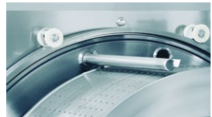
Remoção pneumática da película residual no cesto
