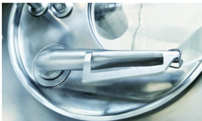
Dispositivo raspador avançado para rendimento ideal porque quase todo o produto é descarregado da centrífuga
