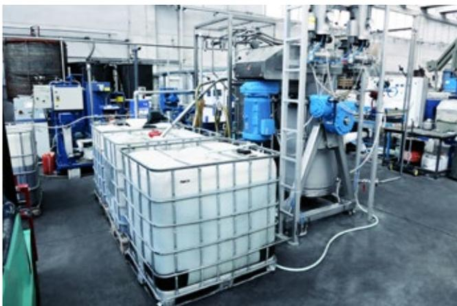
Instalação de filtro de fluxo cruzado dinâmico Krauss-Maffei DCF em uma aplicação de purificação de óleo
