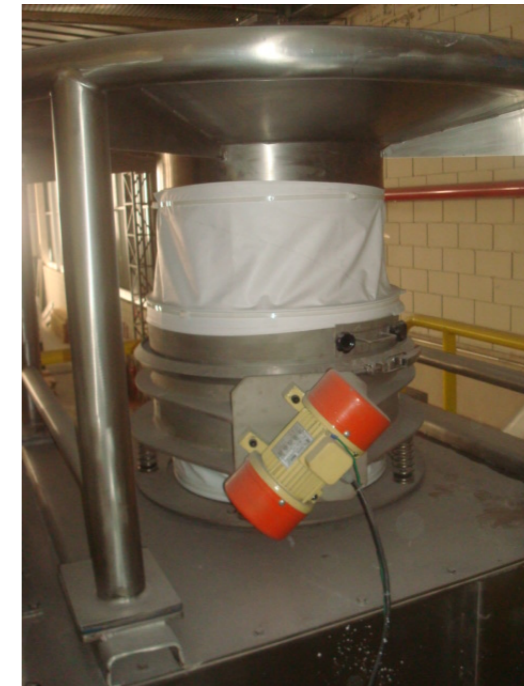
▲ Materiais difíceis de fluir necessitam de acessórios específicos. Aqui um vibrador.
