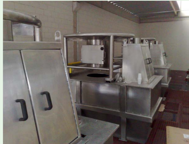
▲ Cada matéria prima em uma estação separada evitando contaminação cruzada e facilitando a automação do processo
